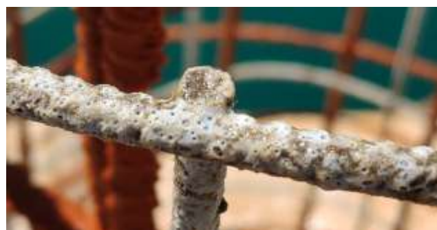
Imagen 2: aspecto real del recubrimiento calcáreo al finalizar la fase de electrólisis.
