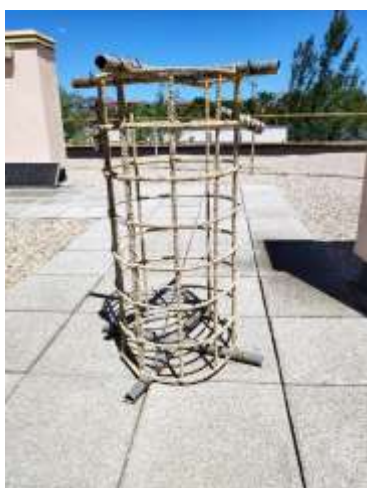
Imagen 1: prototipo de estructura metálica con el recubrimiento calcáreo obtenido por electrólisis.
