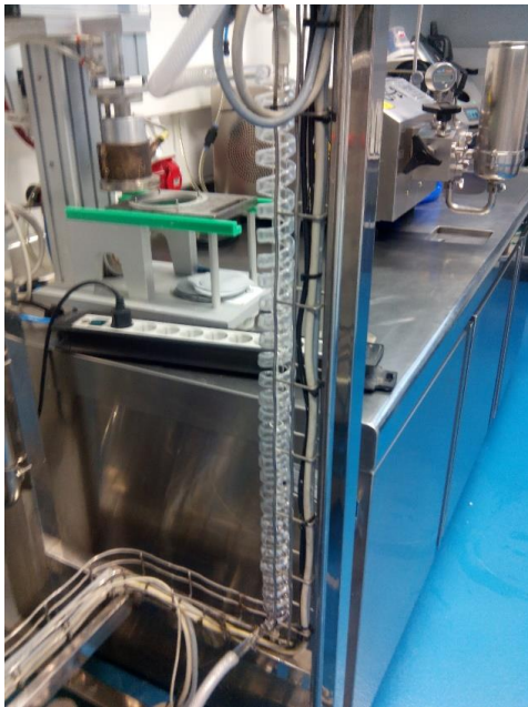
Figura 1. Dispositivo UV-C utilizado para desactivar microorganismos en alimentos líquidos opacos.
