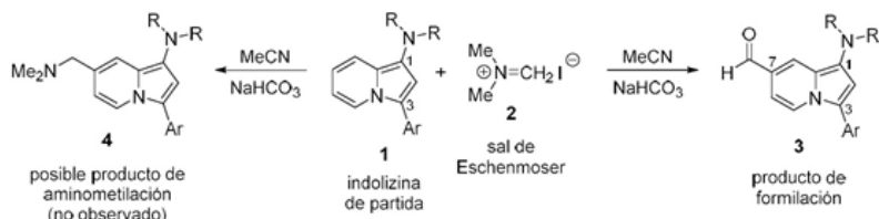
Figura 1: Reacción de una indolizina de estructura general (1), sustituida en las posiciones 1 y 3, con la sal de Eschenmoser (2). Se muestra el producto típico de dimetilaminometilación (4, no formado) y el producto de formilación (3, observado).
