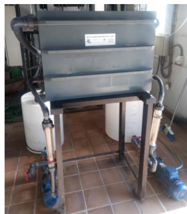
Imagen 2: vista frontal del prototipo a escala planta piloto en la configuración de electrodos planos paralelos, con una capacidad de tratamiento de 15 kg.
