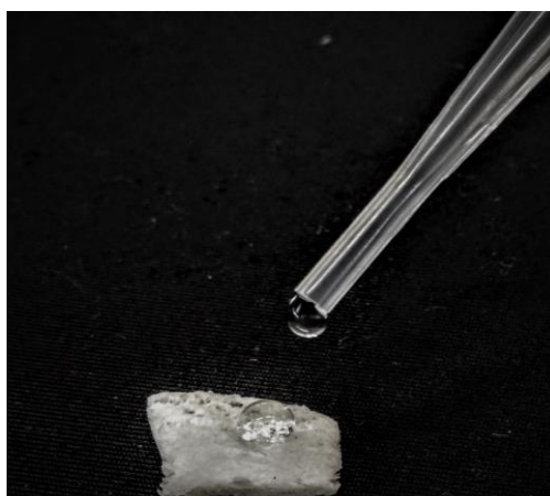
Imagen 1. Aerogel mostrando su capacidad hidrofóbica.
