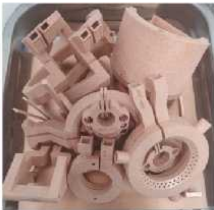
Figura 1. Bobinas de inducción procesadas en una bandeja de fabricación de EBM
