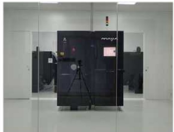
Figura 2. Equipo ARCAM A2 modificado para el procesamiento de cobre en AIDIMME
