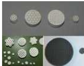
Imagen: Monolitos de grafito (carbonosos) y cordierita (cerámicos)
