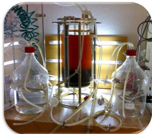
Imagen 2: prototipo del biorreactor en operación.
