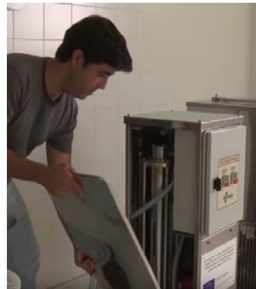
Imagen 2: Dispositivo de desinfección instalado en una máquina industrial
