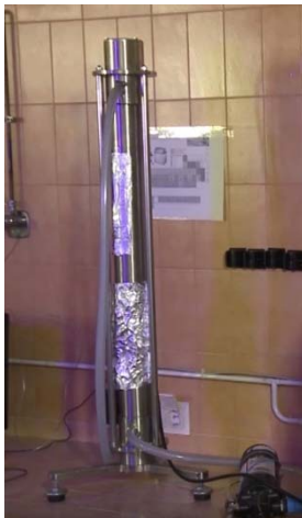
Imagen 1: Dispositivo de desinfección mediante emisión de luz ultravioleta
