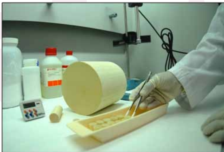
Monolitos usados para soportar la trampa catalítica e instalar en motores
