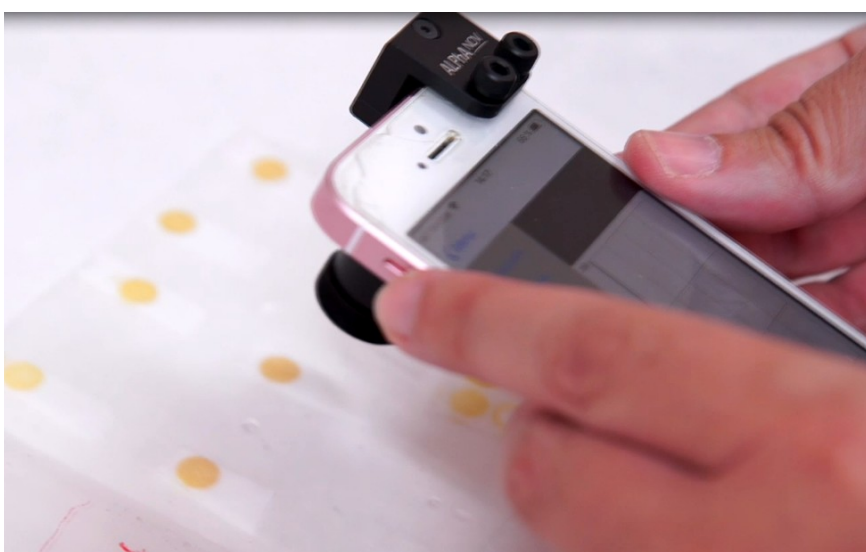
Imagen 2: Dispositivo para la lectura del sensor colorimétrico.
